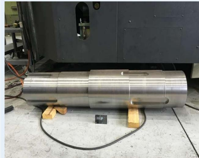
上記写真は大型旋盤加工 φ250mm×1150mm
